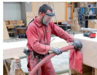
Выдвижной выдувной шест вставляется в деревянную конструкцию до необходимого уровня
