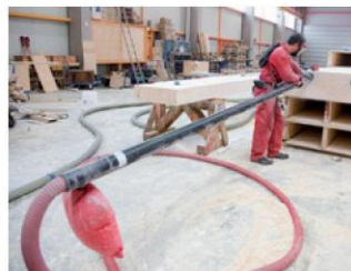
Установка выдувного шеста в деревянный блок
